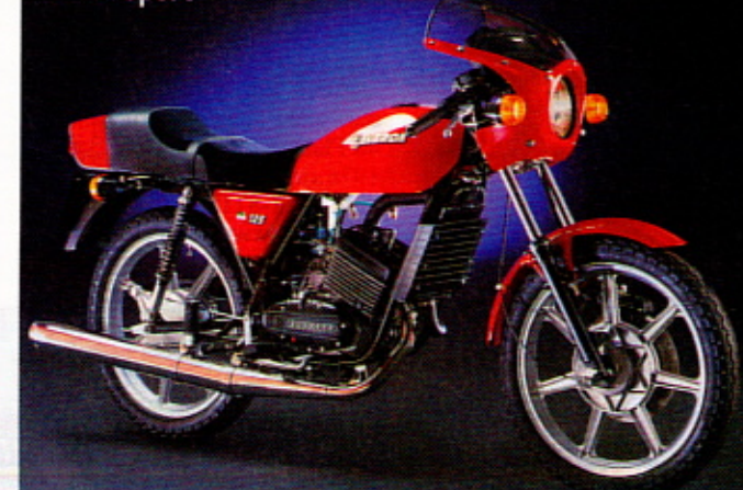
Deutsch-italienische Kooperation: Für den lohnenden italienischen 125er-Markt bezog Laverda den im Hubraum reduzierten KS-Motor
